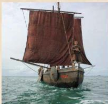
Les coracles étaient les embarcations typiques des Bretons lors des migrations. Le Briois est la réplique d'un coracle du VI e siècle. Ce bateau a une longueur de 17 mètres. Il a une armature de bois couverte de 60 peaux de vaches avec des voiles en lin.
