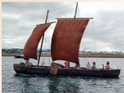
Les coracles étaient les embarcations typiques des Bretons lors des migrations. Le Briois est la réplique d'un coracle du VI e siècle. Ce bateau a une longueur de 17 mètres. Il a une armature de bois couverte de 60 peaux de vaches avec des voiles en lin.
