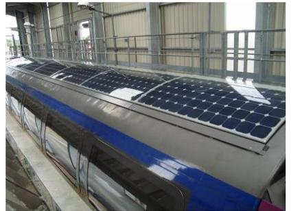
Les cellules « flex-cell » sélectionnées, d'un rendement de 21%, ont été assemblées en film par la fondation Océan Vital, dans le cadre d'un prototypage.
